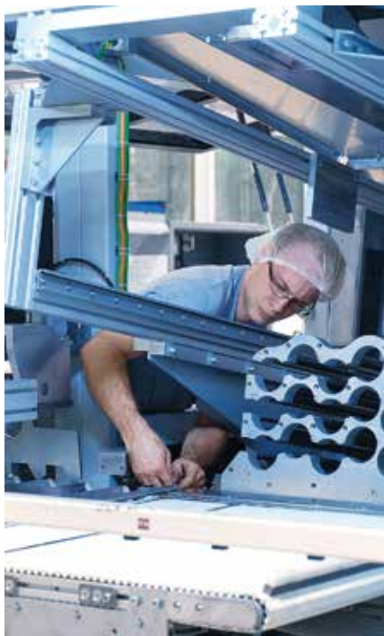
Zum Werkzeugwechsel gehört auch der Umbau der Stapel- und Verpackungseinheit mit Formatwechsel beim Pick-up-Stacker.
