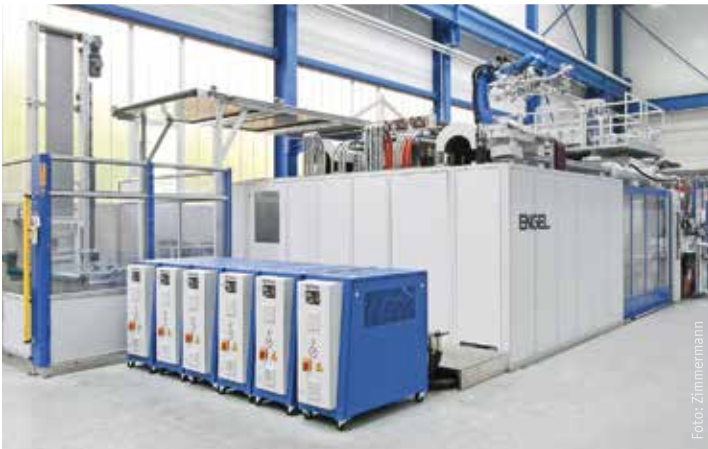
Auf der hauseigenen 2K-Engel-Maschine mit 40.000 kN Schließkraft mustert das Unternehmen die eigenen Werkzeuge nach Kundenwunsch ab, bietet aber auch Abmusterungen für externe Werkzeuge sowie Serien-Produktionsaufträge an.
