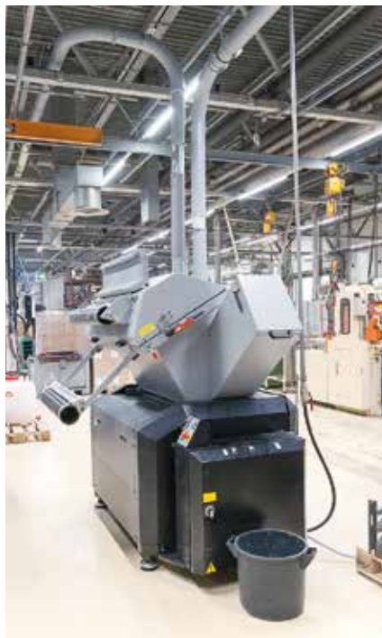
Die Gitterreste gelangen von der Thermoformlinie in die Mühle, so dass das Umlaufmaterial wieder dem Extruder zugeführt werden kann.
