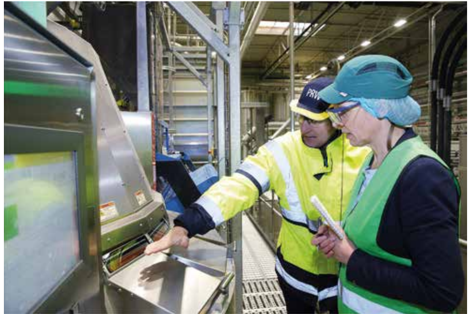
Der Powersort arbeitet mit einer enormen Geschwindigkeit. Er nimmt pro Minute rund 1 Mio. Spektren auf und wertet sie aus. So ist auch bei hohen Durchsätzen die geforderte Materialreinheit gesichert.
