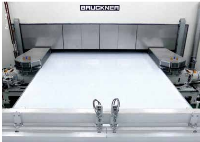
Anlagen für Batterieseparatorfolien (hier ein Detail) erreichen Dimensionen von mehr als 100 m Länge und benötigen mehr als Tausend qm Aufstellfläche.
