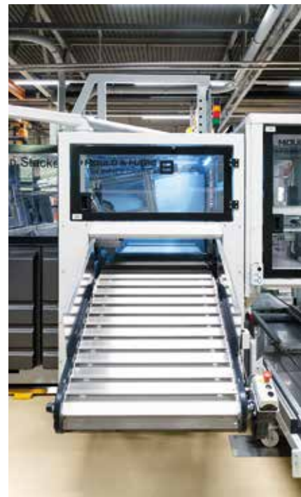
Ist eine definierte Stangenhöhe der Becher erreicht, gelangen die Stangen über die Automatisierung in den Karton oder werden manuell entnommen.
